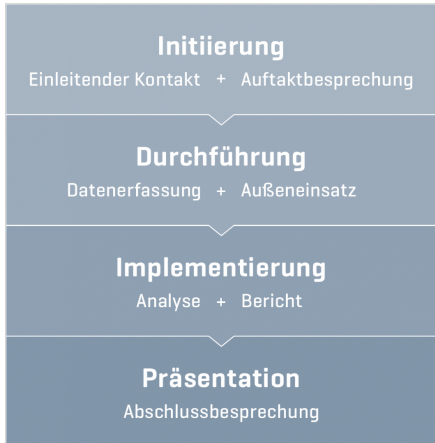
Ablauf Energieaudit nach DIN EN 16247
